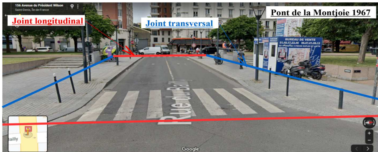
Illustration 11: Localisation schématique des joints de chaussée du Pont Montjoie
